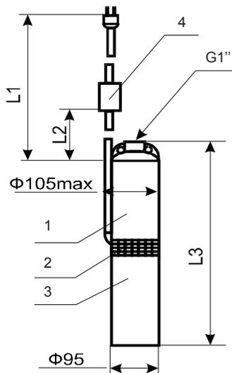
Рис. 1 Габаритные и присоединительные размеры
