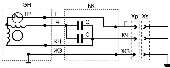
Рис 3. Схема электрическая принципиальная
