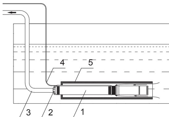
Рис 5. Схема горизонтальной установки электронасоса БЦПЭ: 1 - электронасос; 2 - хомут трубопровода; 3 - трубопровод; 4 - шнур сетевого питания; 5 - кожух для создания охлаждающего направления перекачиваемой воды.
