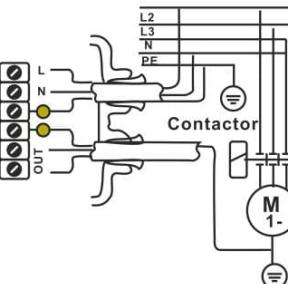
Схема подключения насосов с трехфазным сечением жил, напряжением 380 В, через пульт дистанционного управления.
